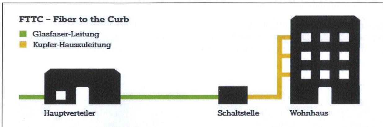
Der ARU wird via Glasfaser an den Hauptverteiler angeschlossen. Die Haushalte bleiben am bestehenden Kupferkabel angeschlossen - dessen Länge durch den ARU auf ein paar hundert Meter verkürzt wurde und dadurch hohe Bandbreiten ermöglicht.
